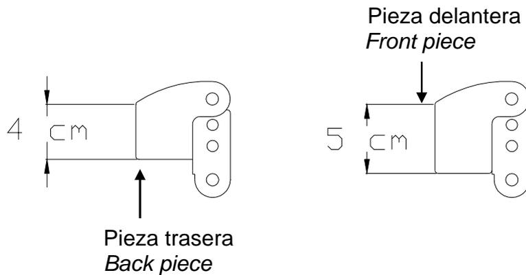
1- Unir la pieza delantera del FA-X208/215 a la parte delantera del rigging de la X-215W siguiendo la posición indicada. Bloquear la estructura delantera mediante el pin del FA-X208/215
