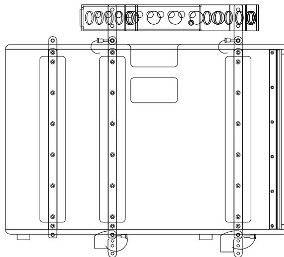
**3-** Unir la X-208 a la estructura delantera y trasera del FA-X208/215+X215W. Bloquear todo el conjunto mediante los pines de la X-208. Situar la guía posicional de la X-208 en la posición “SW”.
