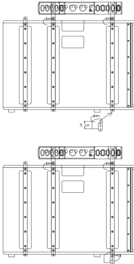
**2-** Unir la pieza trasera del FA-X208/215 a la parte trasera del rigging de la X-215W siguiendo la posición indicada. Bloquear la estructura trasera mediante el pin del FA-X208/215
